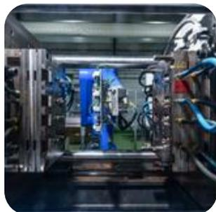
**L'injection plastique**, première expertise, avec plus de 92 presses à injecter de 30 à 350 tonnes équipées de robots. Il s'agit soit de presses électriques, soit de presses hydrauliques mono et bi-matières.
